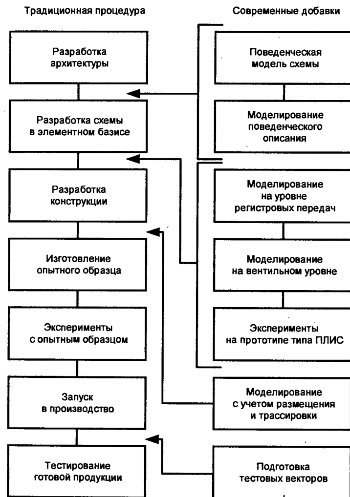
Рис. 2.8. Типовая последовательность проектирования цифровых фрагментов
